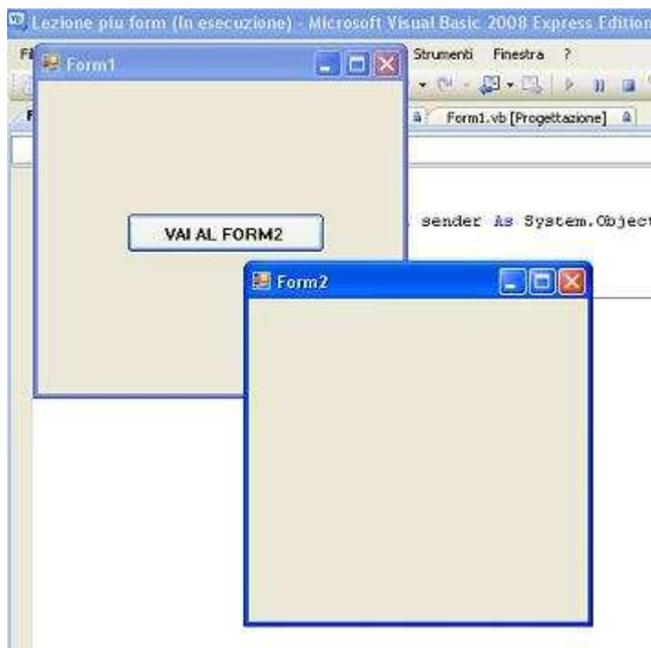
Come si nota, è stato messo in primo piano il secondo form, ma il primo è comunque restato a video se pur in secondo piano. Per evitare il sovrapporsi di tutti i form, è necessario prima di mostrare un form, prima provvedere all'oscuramento dal video del form attivo, utilizzando l'istruzione:
